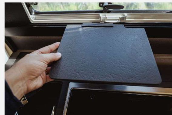
REPISA OBTENIDA ENGANCHANDO UNA PARTE DE LA CUBIERTA DEL FREGADERO
